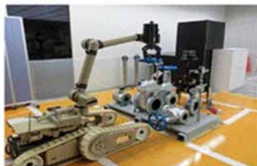
バルブの開閉操作
