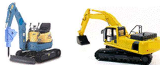
小型・大型無線重機 (屋外のがれきなどの除去)
