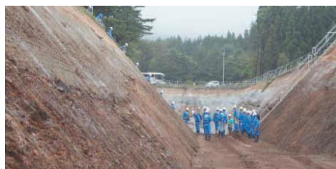
地質調査の例(トレンチ調査)
