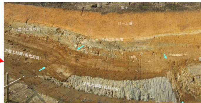
新鮮岩盤と風化岩盤の境界付近に第四系の変状が認められる
