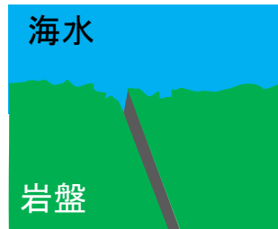
①岩盤表面の侵食
