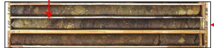
小断層s-19は、ボーリングQB-1孔で確認されていたが、追加ボーリング調査の結果、QB-1孔より西側のボーリングでは確認されなかった。
