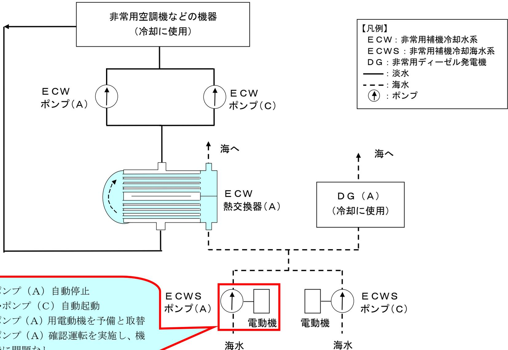
女川1号機非常用補機冷却海水系 系統概要図
