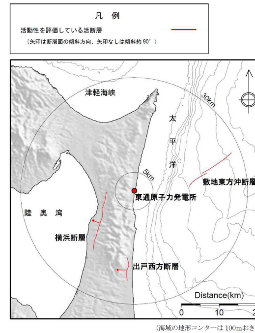
図 1. 東通原子力発電所 耐震設計上活動性を評価している主要な断層
