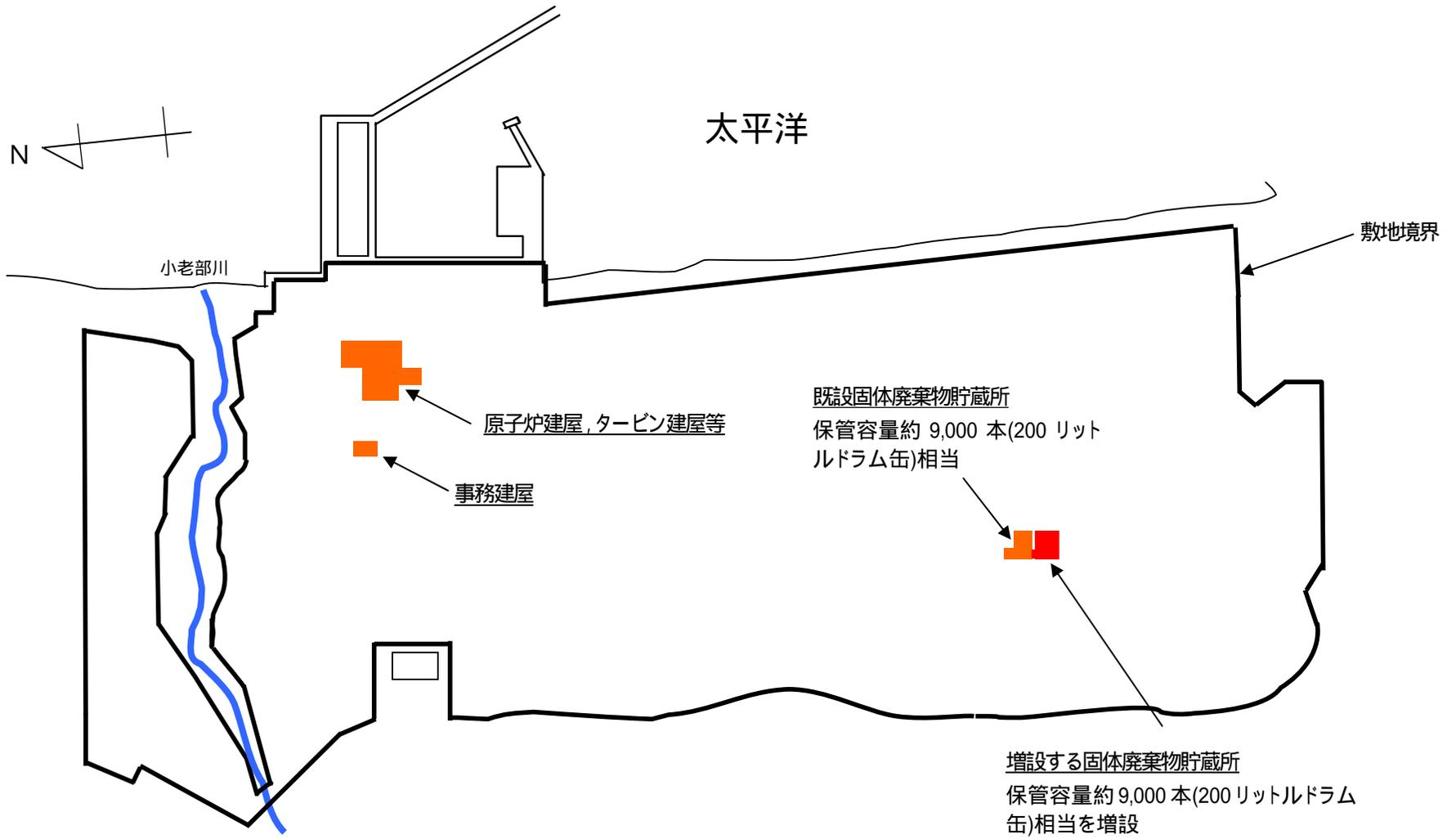
東通原子力発電所における固体廃棄物貯蔵所の増設概要
