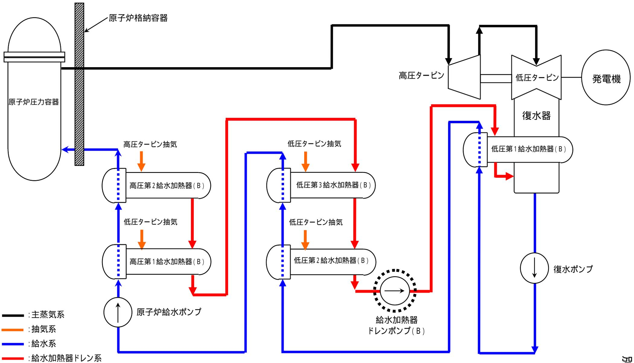
給水加熱器ドレン系 系統概要図 ( B系を代表して記載 )
