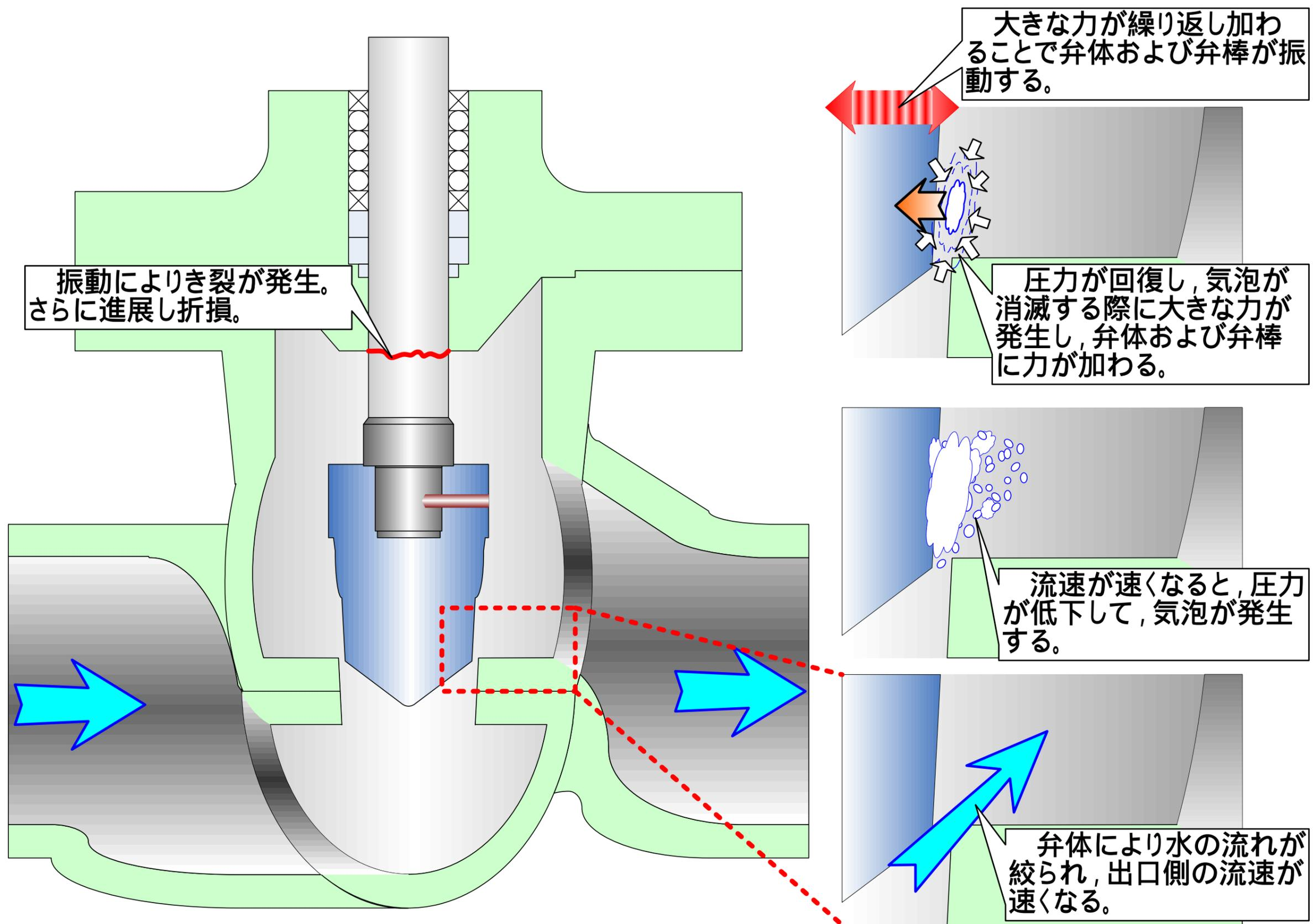
**弁棒折損の推定メカニズム**
