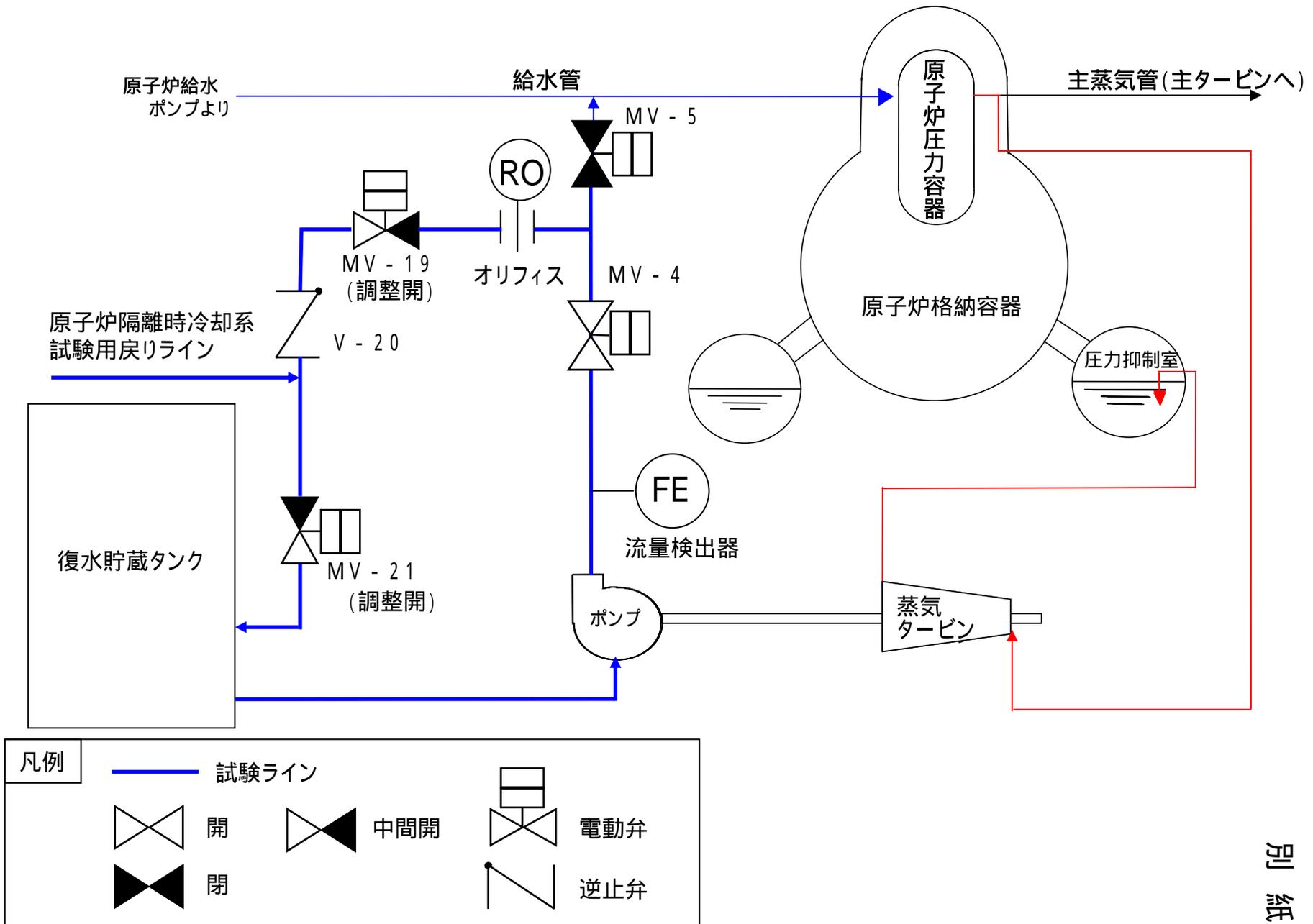
女川原子力発電所1号機 高压注水系 系統概要図
