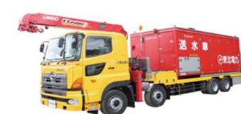
送水車(代替非常用冷却海水ポンプ) (高台に配備)
