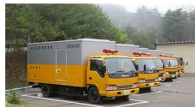
電源車(高台に配備)
