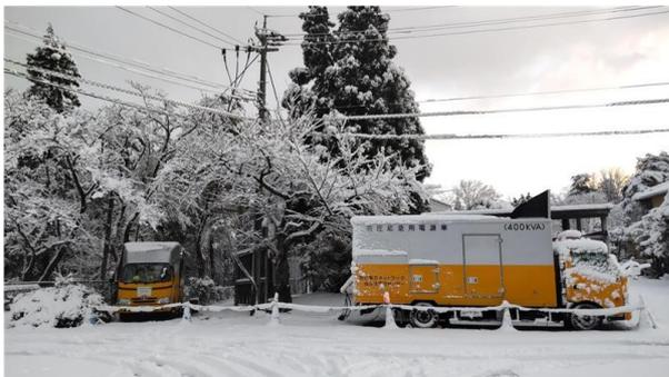
高圧発電機車による応急送電
