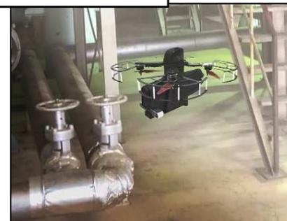
自律的に移動するロボットが自動で各設備を巡りデータ採取
