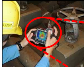
サーモビジョンにより、機器の異常な温度上昇がないか確認
