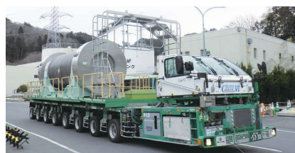
使用済燃料の輸送容器を運搬する様子
