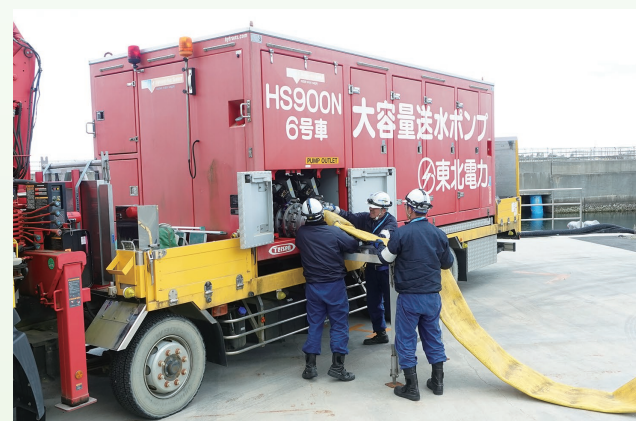
大容量送水ポンプ車へのホース接続
