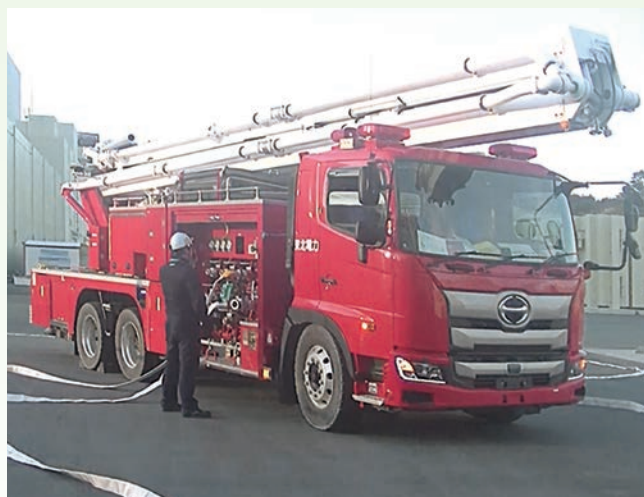
使用済燃料プールへの送水のため大型化学高所放水車を設置する作業員
