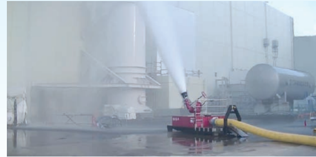
放水砲の機能検査
