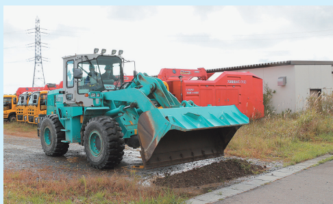
ホイールローダを使用した段差解消訓練
