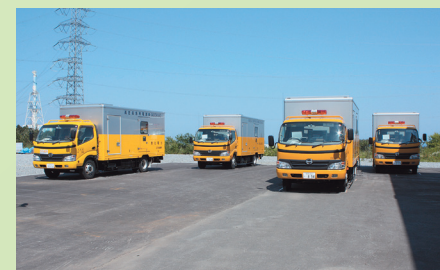
電源車 送電線などからの電力供給が途絶した場合に、複数のルートから中央制御室などへ電力供給します。
