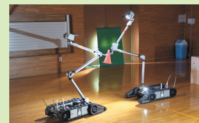
ロボット2台による障害物の除去作業
