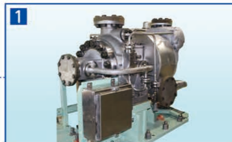
高圧代替注水設備
