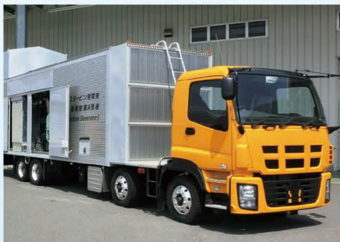
ガスタービン発電機 [多様化]
