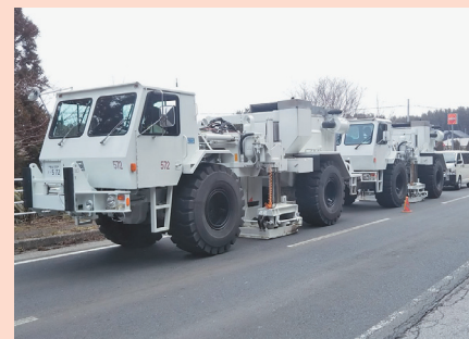
起震車による反射法地震探査 (六ヶ所村泊地区)
