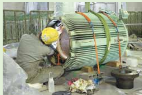
モーター内部を清掃し消耗部品を取り換え
