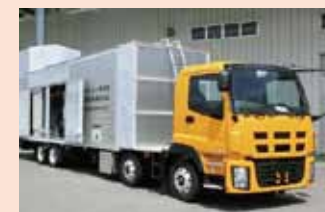
ガスタービン発電機（イメージ） ・2021年度設置予定
