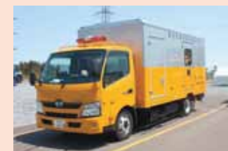
高圧応急用電源車 ・2020年5月までに5台配備済み ・定格出力400kVA/台 ・災害発生時は、被害の状況に応じて、構内の配電柱や原子炉建屋などに接続し電力を供給
