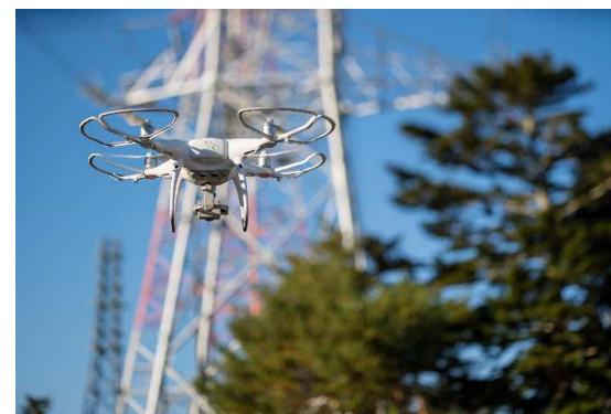
ドローンによる送配電設備の点検
