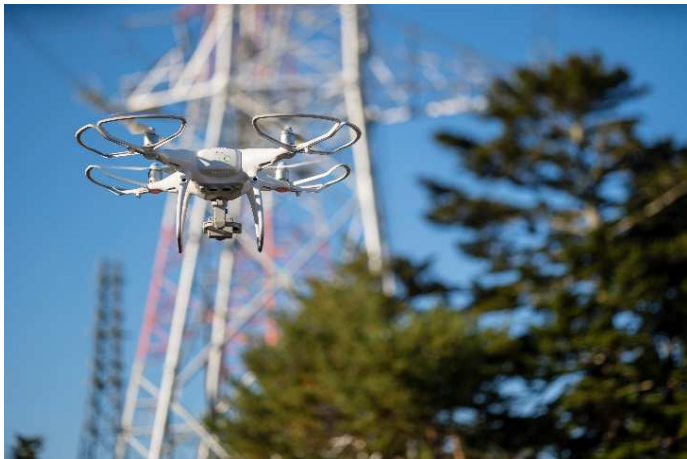
ドローンによる送配電設備の点検
