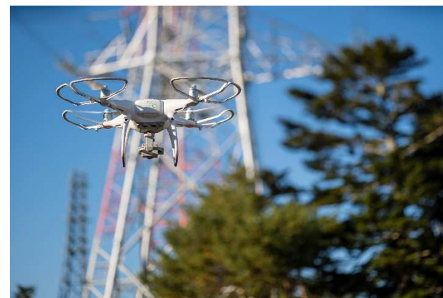
ドローンによる送配電設備の点検
