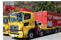
大容量送水ポンプ車
