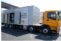
ガスタービン発電機
