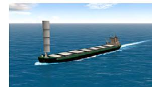
ウィンドチャレンジャー搭載石炭船のシミュレーション画像
