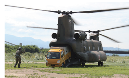
空輸対応型低圧応急用電源車を自衛隊のヘリコプターに搭載
