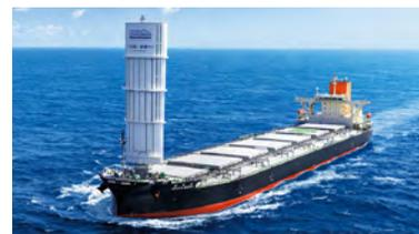
世界初のウインドチャレンジャー搭載石炭輸送船「松風丸」の導入による燃料輸送における環境負荷の低減
