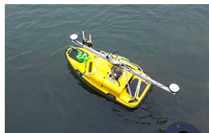
無人リモコンボートによる河川測量
