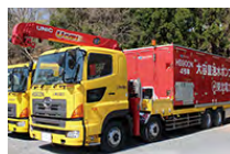
大容量送水ポンプ車
