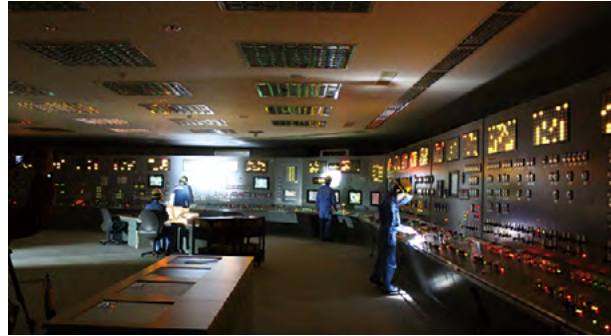
交流電源がすべて使えなくなる事故を想定したシミュレーター装置による運転訓練(原子力技術訓練センター)
