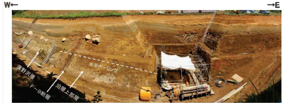
破砕部の試料採取・分析状況(水平ボーリング(Tr-20'-2トレンチ))
