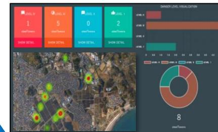
腐食の進む鉄塔を腐食劣化度別に地図上に色分け表示。エリア内の鉄塔の腐食傾向が容易に確認でき、補修工事計画が短時間で策定可能になる。
