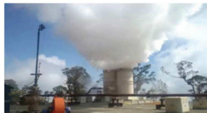
蒸気噴気試験の様子 (ランタウ・デタツ地熱発電事業開発地点)
