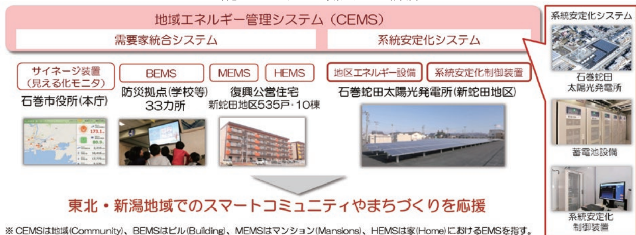
石巻スマートコミュニティ事業のシステム概要図
