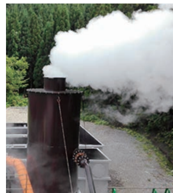
木地山・下の岱地域(秋田県湯沢市)における調査井の仮噴気試験状況
