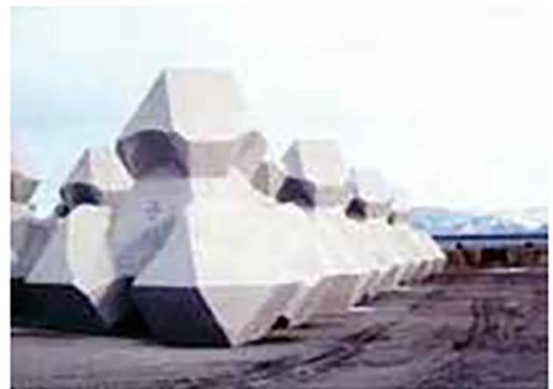
フライアッシュ混合コンクリートで製造された消波ブロック
