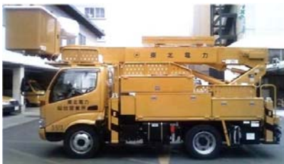
工事中の騒音を低減させるバッテリー駆動型高所作業車
