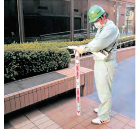
サーベイメーターによる空間線量率測定の様子
