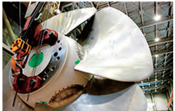
ランナ（水車）の羽根部分を可動式に変更することで水の流量により角度を変え、高効率の発電が可能となりました
