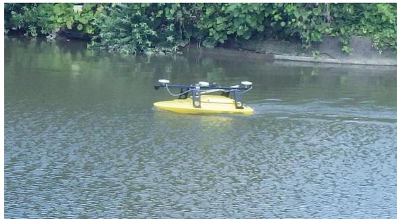
○マルチビーム（水中河床地形の面的計測）を搭載した無人リモコンボートを活用し水中の河床地形を計測します。
