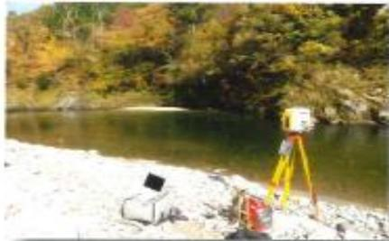
地形・地物・構造物等の形状観測に3Dレーザースキャンを活用し、次元点群データから各種図面作成を行います。
