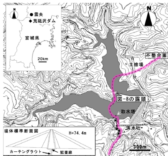
図-1 位置図 ★：右岸変状箇所，☆：開口亀裂 国土地理院 1/25,000地形図「切留」に加筆。
