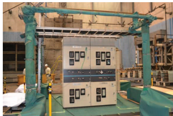
参考図2-1 HEAF試験状況 (M/C試験時)
